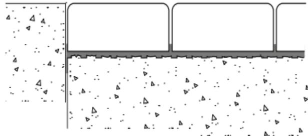
Una vez que se hayan completado todos los cortes, deberá utilizar un martillo astillado con cincel para eliminar el concreto entre cortes. Cincele suavemente el concreto en los cortes más cercanos al borde de transición de la puerta del garaje. Retire todo el concreto cincelado. Una superficie rugosa está bien.
